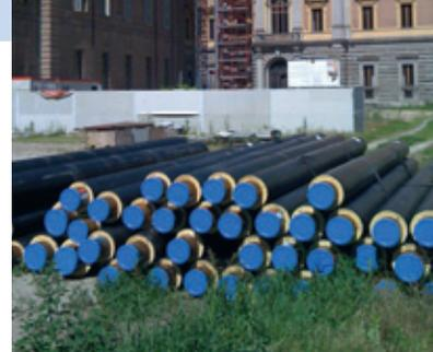
ZINCHITALIA Spa fabrique des tubes pré-isolés conformes aux normes en vigueur dans le domaine des tuyauteries pré-isolés pour chauffage EN 253, EN 448, EN 488, EN 489.
